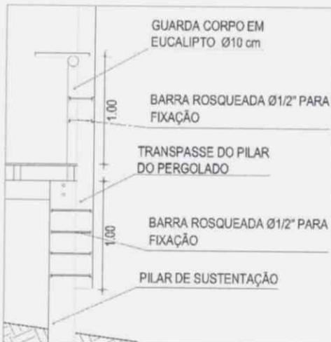
**Observações:** Detalhe de fixação guarda corpo / pilar do pergolado / pilar de sustentação.
