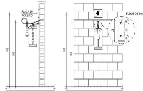
OBSERVAÇÃO: OS EXTINTORES DEVERÃO SER FIXADOS A 1,80m DO PISO, SEMPRE EM ALVENARIA OU QUANDO A PAREDE INDICADA FOR DE GESSO ACARTONADO, INSERIR NA PAREDE PERFIL DE AÇO GALVANIZADO DE REFORÇO INTERNO.
