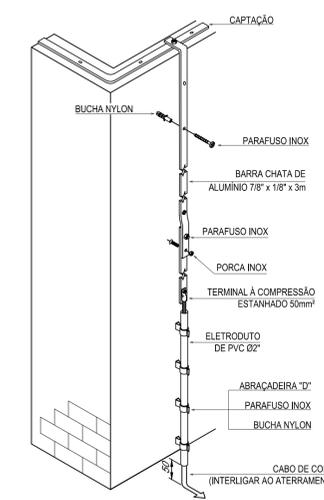
**DESCIDA APARENTE COM BARRA CHATA DE ALUMÍNIO 7/8" x 1/8" INTERLIGANDO CAPTAÇÃO EM BARRA CHATA AO ATERRAMENTO SEM ESCALA**
