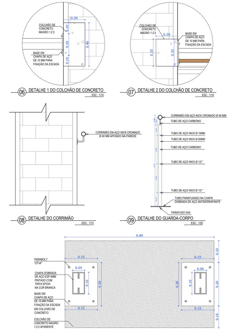
10 DETALHE DA FIXAÇÃO DA ESCADA ESC.: 1/5
