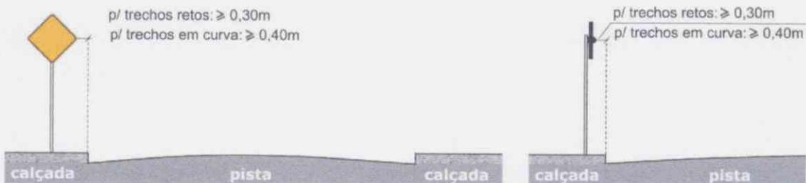
A regra geral de posicionamento das placas de sinalização, consiste em colocá-las no lado direito da via no sentido do fluxo de tráfego que devem regulamentar.
